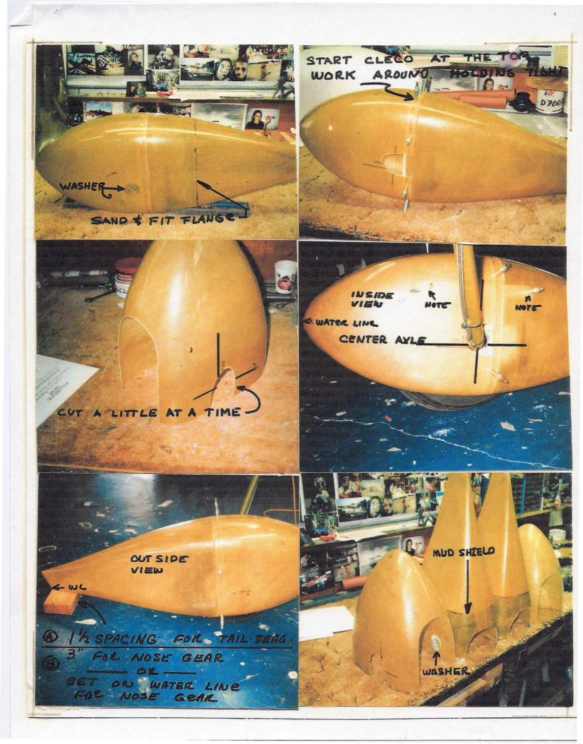
MUD SHIELD 3/16 PLY MOUNT 678 FROM TOP. COVER 8"2 CLOTH 1 LY. AL. WASHER 2 MM 244 -B"CLOTH COVEL GRAN ANN. - M WAY SARAHAN AN 😁 jaha dapat dari s RCR AFT OF LONG 计行 机数学 -W2 DOT. AXLE XXXXX 2LY OF BOZ CLOTH I' WIDE 1. G. AROUND CUT OUT
